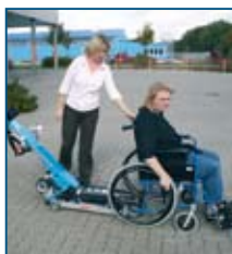
Den Rollstuhl über den Treppenkuli fahren... Move the wheelchair across Stairmate...
